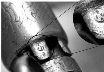
Рис. 5. Фото клейм контрольного відстрілу на барабані револьвера.
